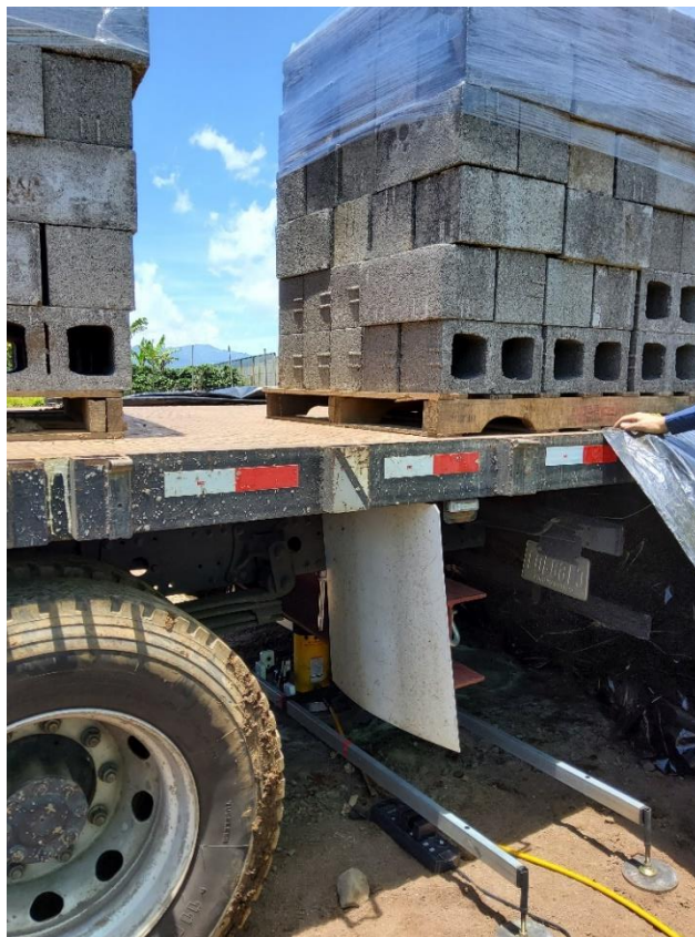
Fotografía 6. Tarimas adicionales colocadas para la prueba de placa: M-1415-2022.
