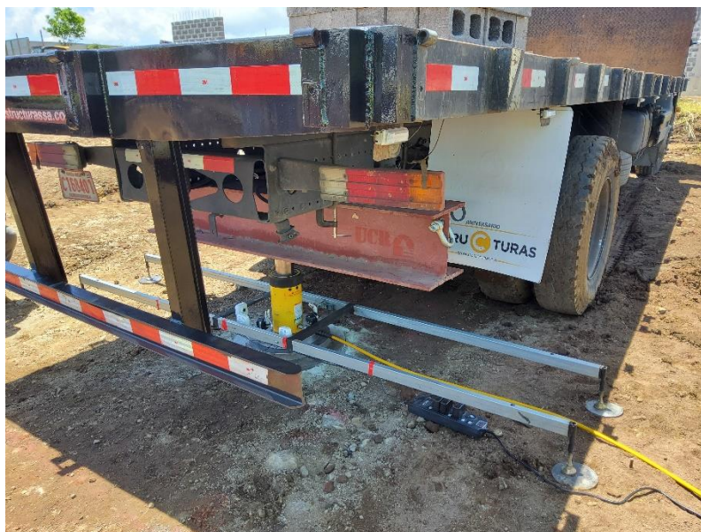
Fotografía 3. Montaje final prueba de placa: M-1414-2022.
