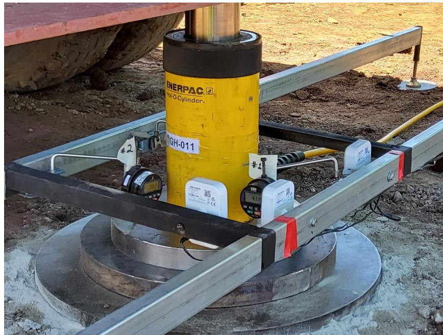
Fotografía 4. Detalle ubicación de deformímetros, celda y pistón de aplicación de carga para prueba de placa: M-1414-2022.
