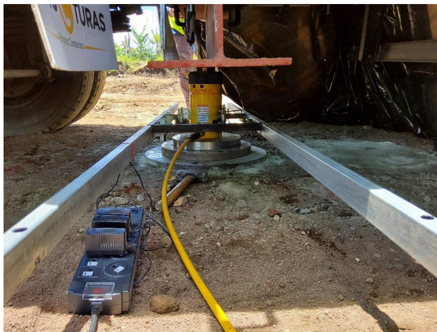
Fotografía 7. Ejecución de prueba de placa: M-1415-2022.
