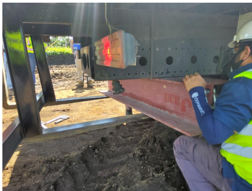
Fotografía 1. Instalación de viga de carga en ejes del chasis del vehículo de reacción.
