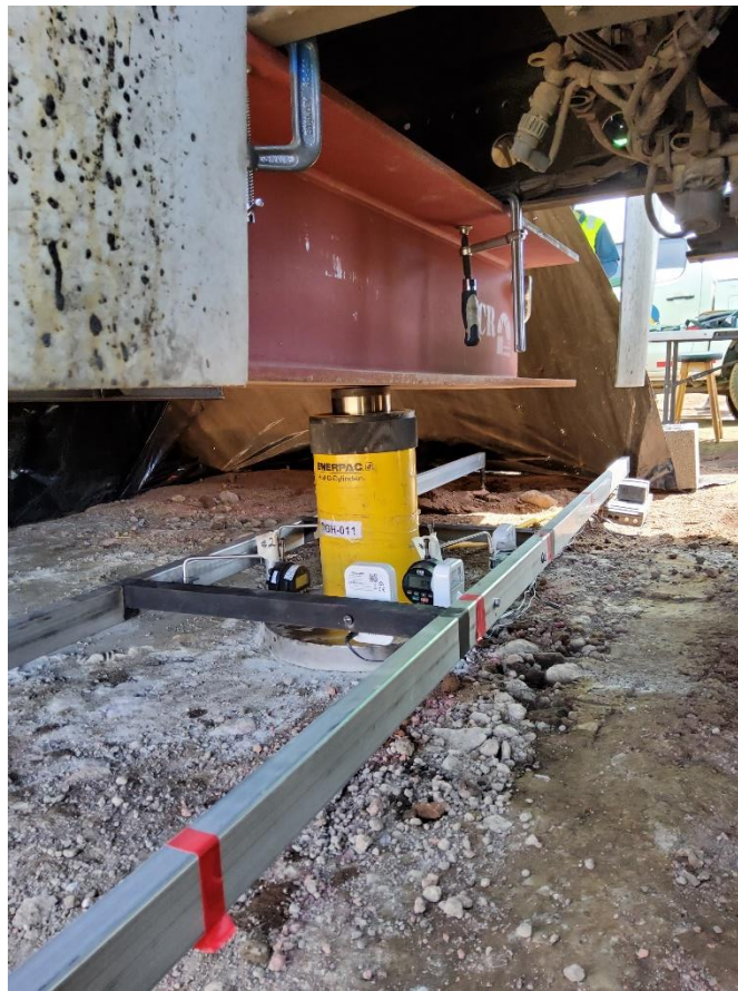
Fotografía 10. Montaje para la prueba de placa: M-1416-2022.
