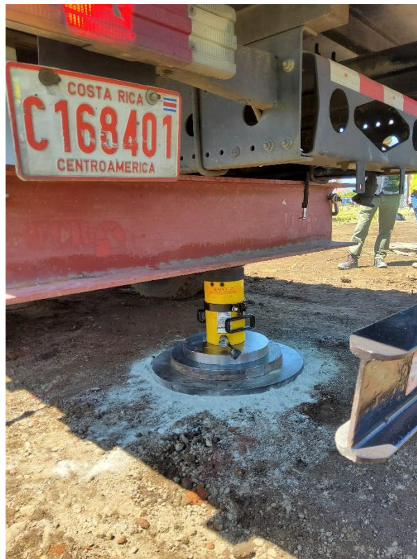
Fotografía 2. Arreglo de 3 discos para prueba de placa: M-1414-2022.
