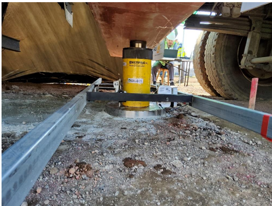
Fotografía 9. Preparación de la viga de reacción para la prueba de placa: M-1416-2022.
